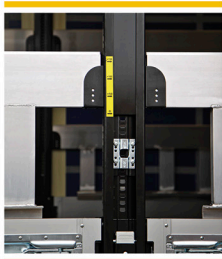
Механизм блокировки центральной стойки после поднятия крыши на требуемый уровень
